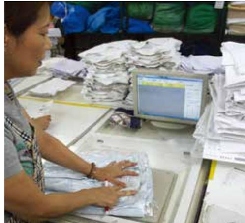
▲9年前にICタグシステムを導入。写真は出荷時の読み込み作業で、5枚重ねてスキャン。入出荷管理とともに、納品書・請求書発行にも連動している
